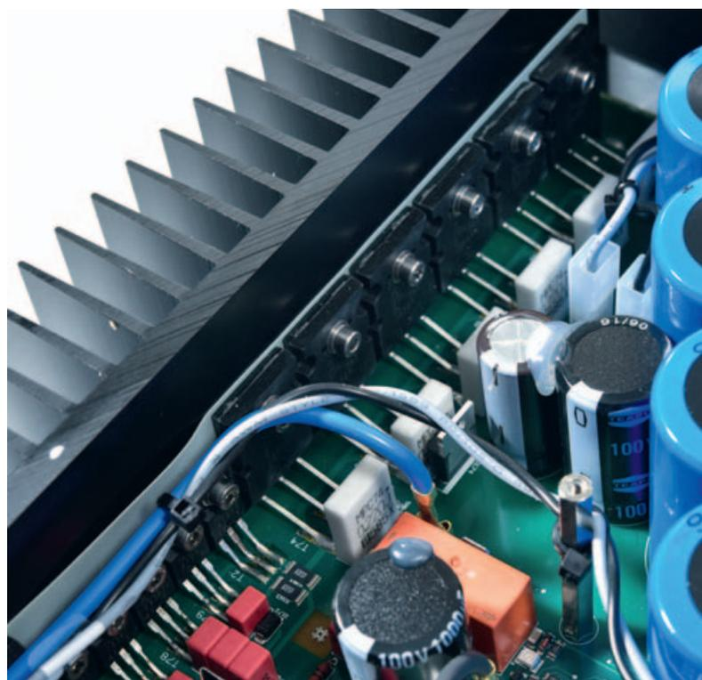
Hier wird es warm. Den Strom durch einen angeschlossenen Lautsprecher übernehmen eine ganze Reihe von Leistungstransistoren auf dem Kühlkörper, die im Parallelbetrieb arbeiten.
